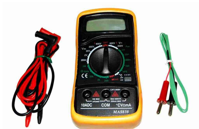
Ilustração 6: Multímetro Digital.
