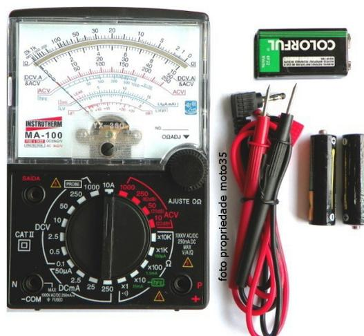
Ilustração 5: Multímetro Analógico.
