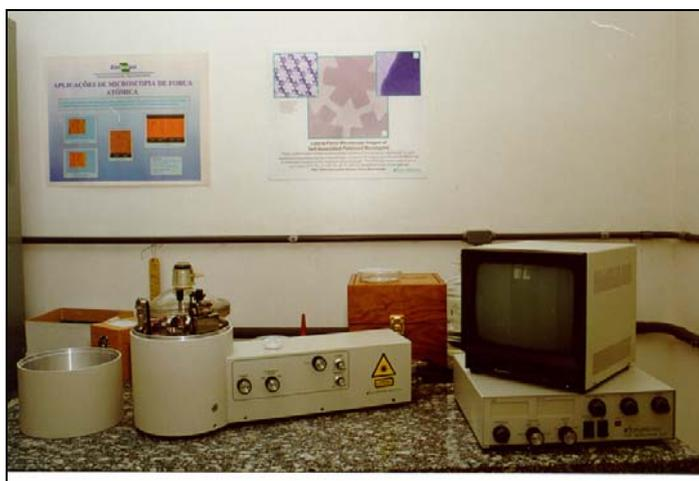
**Figura 5** - Microscópio de força atômica TMX 2010 Discoverer da Topometrix.
